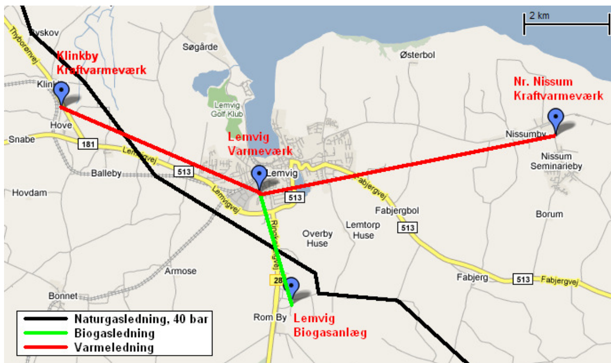
Figur 4: Løsningsforslag # 2. Her er der etableret varmetransmissionsledninger mellem Lemvig Varmeværk og henholdsvis Klinkby Kraftvarmeværk og Nr. Nissum Kraftvarmeværk.
