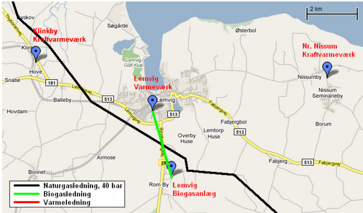
Figur 2: Reference-situationen (# 0) med en biogasledning fra Lemvig Biogasanlæg til Lemvig Kraftvarme. Herudover er 40 bars naturgasledningen tegnet ind (Klinkby Kraftvarmeværk og Nr. Nissum Kraftvarmeværk forsynes med naturgas fra 4 bars nettet).
